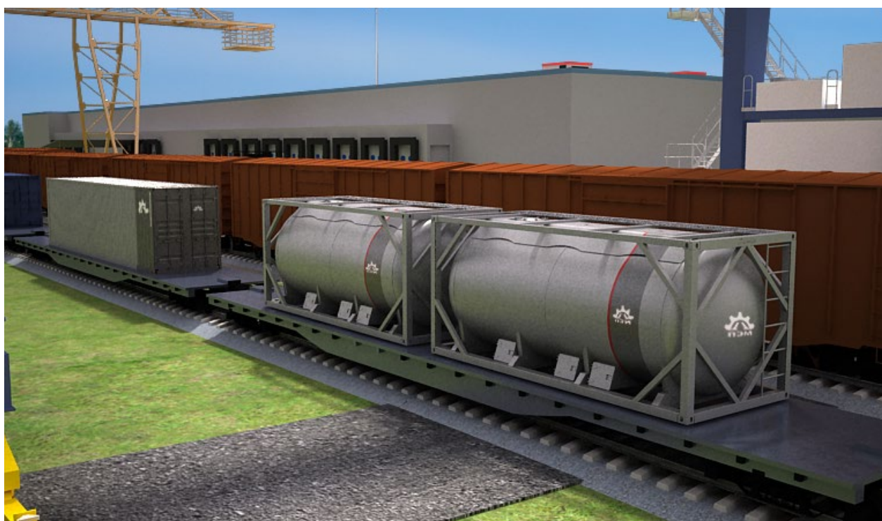
Перевозка железнодорожным транспортом в габарите «02-ВМ»
