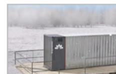
Устройство прошло низкотемпературный тест в строгом соответствии со стандартом 1ЕС, что позволяет эксплуатировать КРУЭ в суровых климатических условиях.
