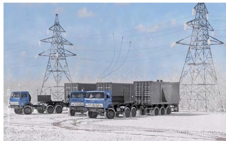
Модульные ДЭС могут работать как в автономном режиме, так и совместно с централизованными системами электроснабжения и тепла. Все пакетируемые ДЭС производства ООО «ПитерЭнергоМаш» оснащаются встроенными в контейнеры системами охранно-пожарной сигнализации (ОПС) и при необходимости системами контроля и управления доступом (СКУД), видеонаблюдения, пожаротушения и др. Комплектация блок-модуля ДЭС согласовывается с заказчиком.
