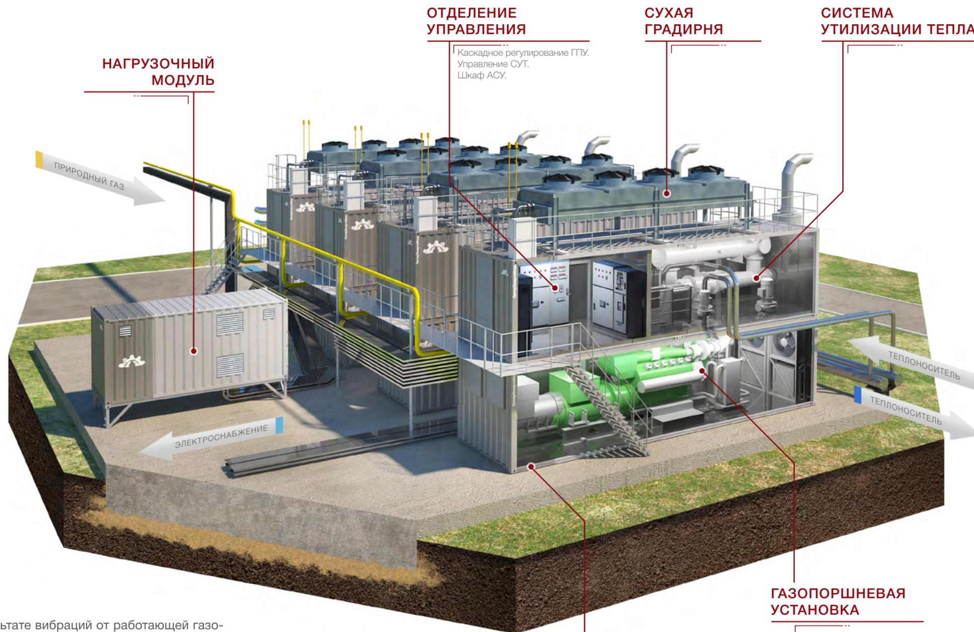
В данном примере описана газовая теплоэлектростанция, выполненная в двухэтажном контейнерном исполнении. В основе конструкции применены два 40-футовых контейнера, специально спроектированные под данный вид оборудования.
